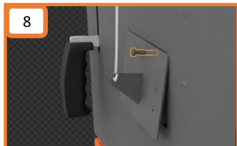
Minimalne otwarcie klapy głównej - klapa nigdy nie może być całkowicie zamknięta
